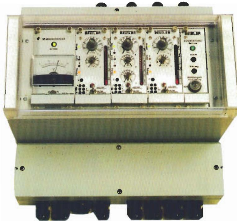
Die Gasmeldezentrale **GMZ-3N** ... wurde als kleines, kompaktes Gerät entwickelt, das eine zentrale Auswertung von bis zu drei **Meßstellen** ermöglicht. Sie ist in einem **19"-Einschubrahmen** modular aufgebaut und mit folgenden leicht auswechselbaren Einschüben versehen:
