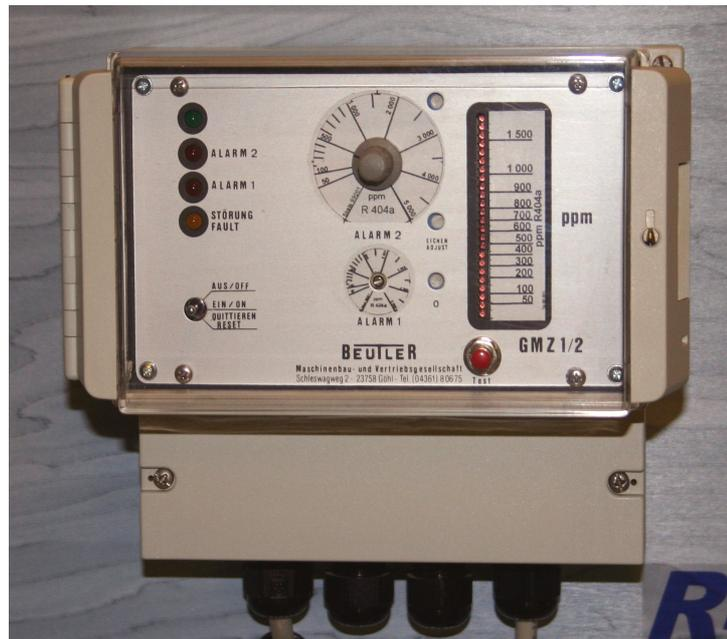
Das Gasmeldegerät GMZ-1/2 ist ein robustes Betriebsmessgerät für Gase und Dämpfe, das weitgehend wartungsfrei und funktionssicher Räume, Lüftungskanäle, Kälteanlagen, Labors usw. auf das Entstehen gefährlicher Gaskonzentrationen überwacht und verzögerungsfrei meldet.
